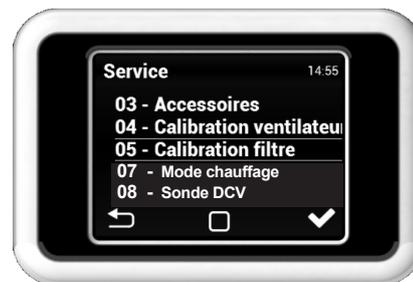
Le calibrage doit être réalisé au premier démarrage et après chaque changement de filtre.
