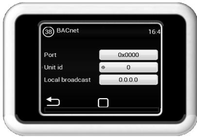
Le menu BACnet sert au réglage de la communication BACnet.
