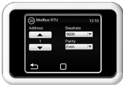
Le menu MODBUS RTU sert au réglage de la communication Modbus.
