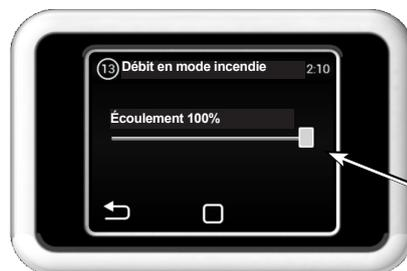
Réglage débit de l'unité lors de l'ouverture du contact FIRE (entrée sur les bornes 15/16)
