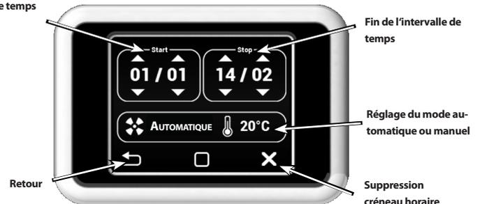
En mode manuel, il est possible de sélectionner, hormis la température de consigne, la puissance du ventilateur.
